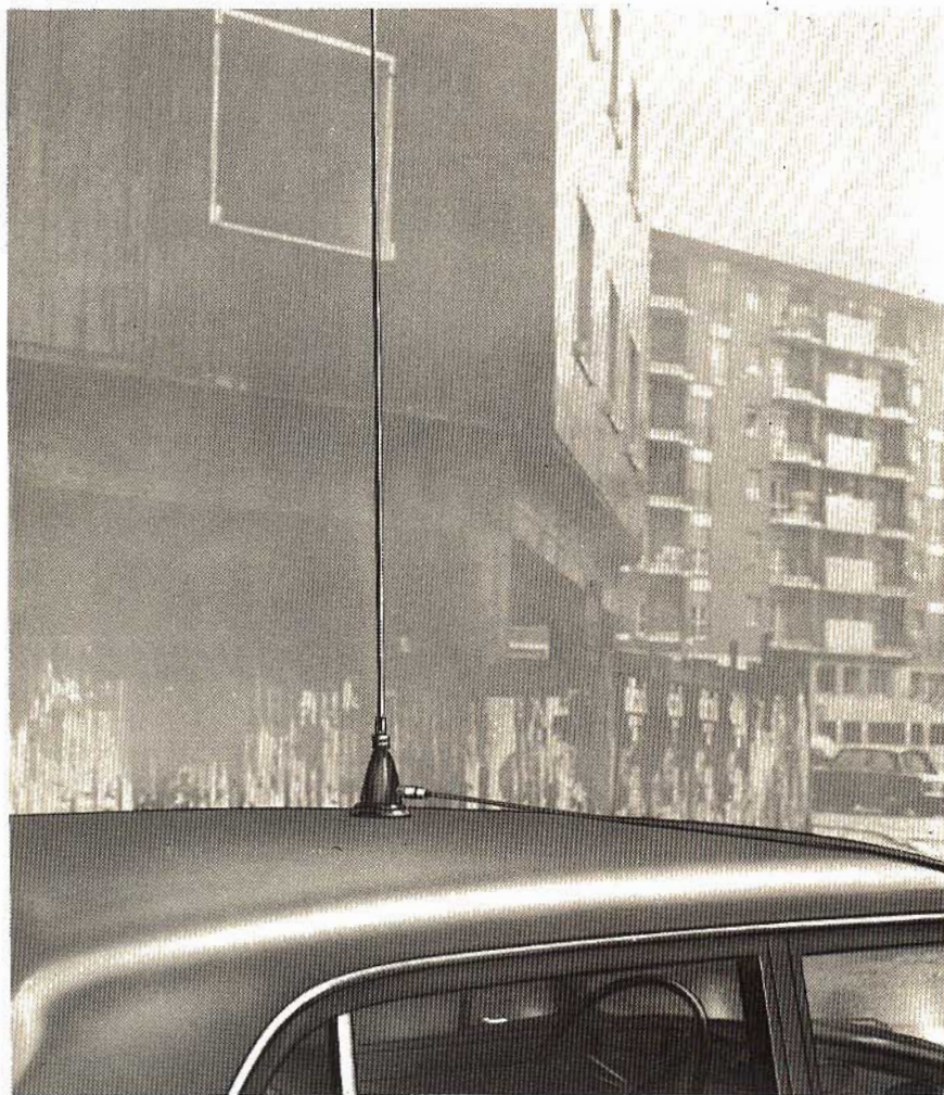
Fig. 5 - Antenna a base magnetica Kathrein Modello K 51132 operante con un tratto irradiante di lunghezza pari a 5/8 lambda e quindi di rendimento sensibilmente superiore alla normale antenna un quarto d'onda. E' possibile utilizzare anche l'Antenna Kathrein Modello K 50522, essa pure per i 144 \div 146 MHz.
